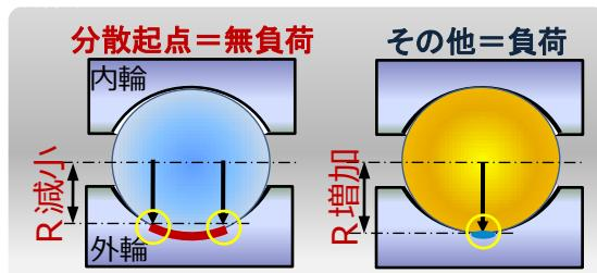
ADBは、保持器の代りに、外輪に1～数箇所の分散起点（凹部）を設けています。ここで玉と外輪との接点 [図中○] を、外輪の溝底から凹部の 淵2箇所に移すことで、玉の有効半径Rを減少させます（下図）。
